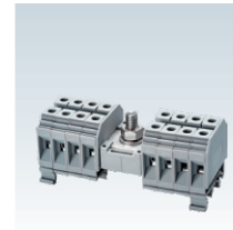
CDB10 Entrada : 10 - 35 mm 2 Saída : 1.5 - 10.0 mm 2 114/57A, 800V, 6.0/1.2Nm
