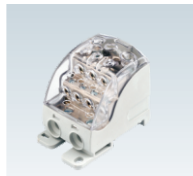
DB185 68 x 94 x 53.3 mm Entrada: 1 x 95 - 185 mm 2 Saída: 2 x 4 - 35 mm 2 Saída: 3 x 2.5 - 25 mm 2 Saída: 4 x 1.5 - 16 mm 2 353A, 1500V, 19.0/2.5/2.0 Nm
