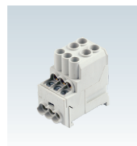
DB25 52,1 x 55,4 x 30,5 mm Entrada: 2 x 2,5 - 25 mm 2 Saída: 4 x 1,5 - 10 mm 2 100 A, 690 V, 3,0 / 2,0 Nm
