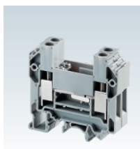
CDTTUSH 58,7 x 63 x 16 mm 1,5 - 10,0 mm 2 10 A, 160 V, 1,2 Nm
