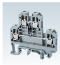
CDL4U(E) (Diodo) 55,7 x 55,5 x 6 mm 0,2 - 4,0 mm 2 32 A, 500 V, 0,5 Nm
