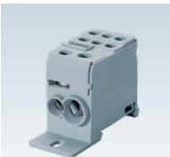
DB35 50.8 x 74.5 x 27 mm Entrada: 1 x 6 - 35 mm 2 Saída: 1 x 6 - 16 mm 2 Saída: 6 x 2.5 - 10 mm 2 125 A, 1000 V, 6.0 / 3.0 Nm
