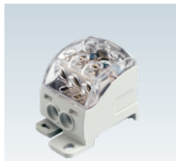
DB70 55.2 x 74.45 x 41.6 mm Entrada: 1 x 10 - 70 mm 2 Saída: 2 x 2.5 - 25 mm 2 Saída: 3 x 1.5 - 16 mm 2 160A, 1000V, 10.0/2.0 Nm
