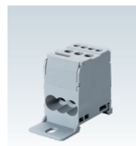
DB16 50,8 x 66 x 27 mm Entrada: 3 x 6 - 16 mm 2 Saída: 4 x 2,5 - 6 mm 2 76 A, 1000 V, 1,2 / 0,8 Nm
