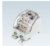
PDB400 77.5 x 94 x 53.3 mm Entrada: 1 x 35 - 120 mm 2 Saída: 2 x 4 - 35 mm 2 Saída: 3 x 2.5 - 25 mm 2 Saída: 4 x 1.5 - 16 mm 2 250A, 1500V, 19.0/2.5/2.0 Nm
